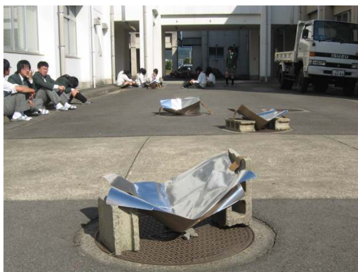
キッチン用アルミシートを用いたソーラークッカーによる加熱実験
